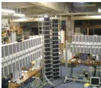
Fig. 2 構築した直交3軸スピーカーアレイ
