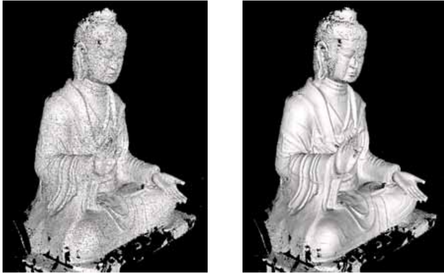
図 3 1 Cyrax2400 によって計測した距離画像の誤差補正結果 (左：補正なし、右：補正あり)
