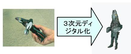
図 7 視体積交差法による手持ち物体の3次元再構成
