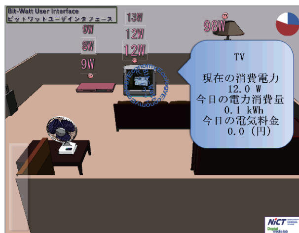
図-8 家電ごとの電力消費量の見える化(情報通信研究機構との共同研究)
