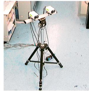
図 6: 擬似装着型能動視覚センサ
